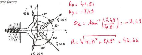
**Exercice 15:** Les forces  $\vec{F}_1$ ,  $\vec{F}_2$ ,  $\vec{F}_3$  schématisent les actions exercées par d'autres roues dentées.
